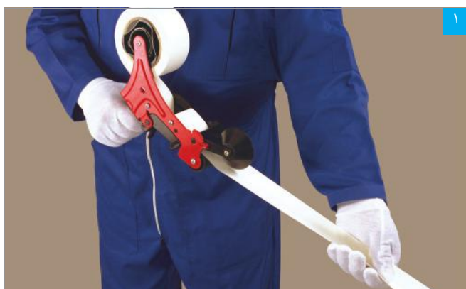
خم کردن نوار درزگیر با دستگاه تازن
